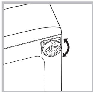
1. Установите стиральную машину на ровном и прочном полу, не прислоняя ее к стенам, мебели и прочим предметам.
