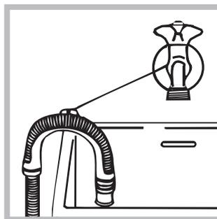
или поместите шланг в раковину или в ванну, закрепив прилагающуюся направляющую крану (см. схему). Свободный конец сливного шланга не должен быть погружен в воду.
